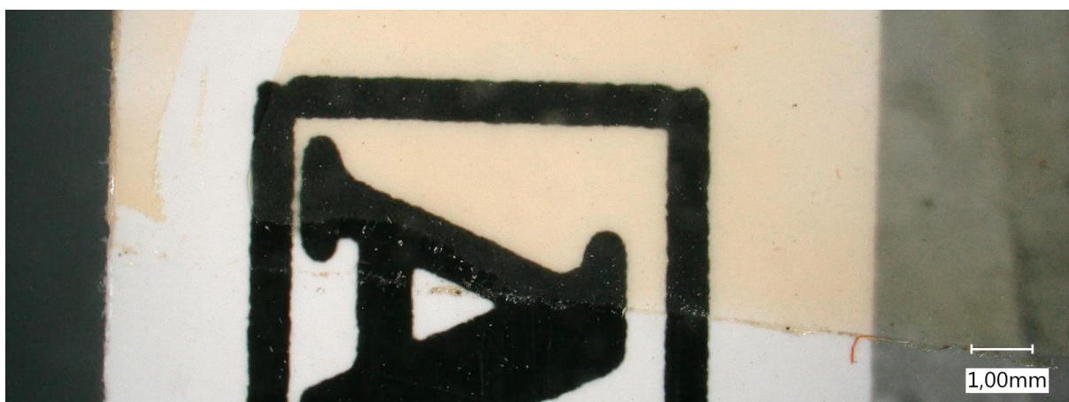
Abb.15 Klebstoffrückstände an der Fotoschicht (x50 Vergrößerung) – vor der Reinigung
