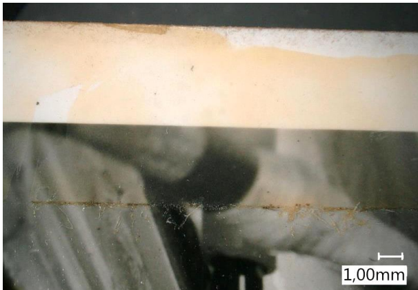
Abb.17 Klebstoffrückstände an der Fotoschicht (x50 Vergrößerung) – vor der Reinigung
