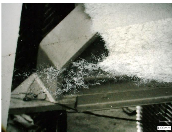
Abb.09 Festklebende Fragmente des Barytpapiers (gelöst von der Rückseite eines Fotoabzugs) auf der Fotoschicht
