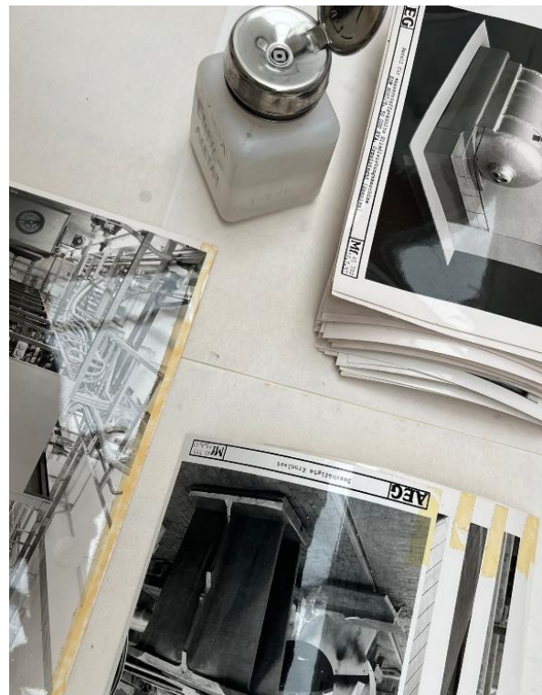
Abb.04 Gelbe Klebstoffrückstände an den Rändern der Fotoabzüge
